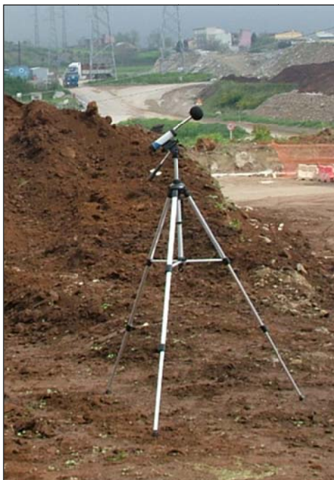
Figura 2 – Vista de fonometro posizionato su treppiede mobile (misure a breve periodo)
